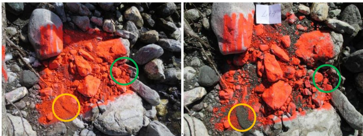
Abb. 4.23 Dokumentation Geschiebebewegung am Standort Litzirüti 4. Aufnahme 9. März 2015, links zu Beginn der Versuchswochen und am Ende der Versuchswochen am 13. März 2015, rechts. Die Kreise kennzeichnen Bereiche, in denen während den Versuchen Geschiebe mobilisiert wurde. Die sich entsprechenden Bereiche wurden mit derselben Kreisfarbe markiert.
